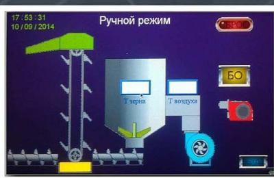
В системе управления установлен сенсорный экран с интуитивно понятным интерфейсом.
